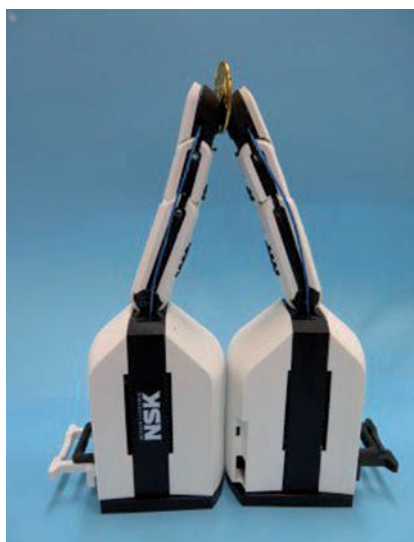
Dva prstové moduly vyvinuté NSK a German Aerospace Centre držia kovový disk.
