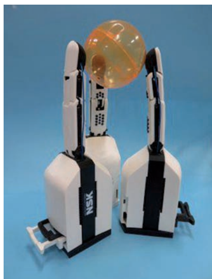
Trojica prstových modulov vyvinutých NSK a German Aerospace Centre drží plastovú guľu.
