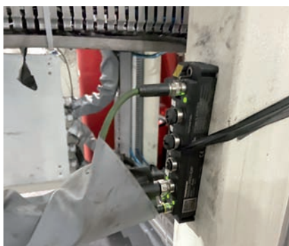
Modul TBEN S RFID od spoločnosti Turck s vyrovnávacou pamäťou 16 kB ponúka pôsobivý výkon.
