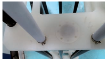
Integrovaná RFID značka umožňuje jedinečnú identifikáciu každého nosiča plátka a jeho priradenie k výrobnéj zákazke.
