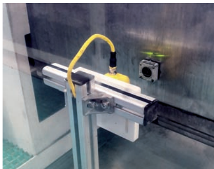
Vysokofrekvenčné čítacie/zapisovacie hlavy na každej procesnej stanici zaisťujú spoľahlivý zber údajov.
