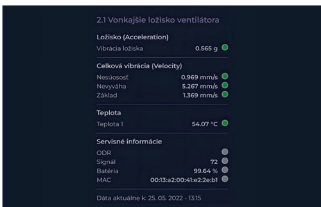
Prehľad s monitoringom porúch
